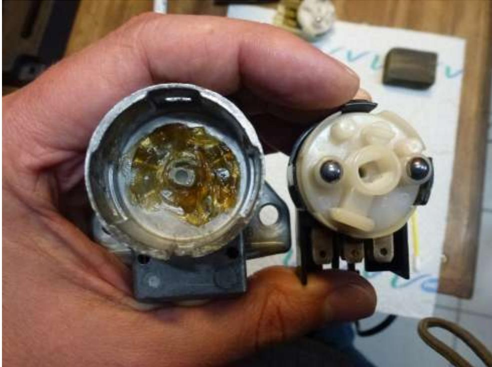
Bei beiden Kunststoff Gehäusen, womit die runde Kontaktplatte eingeklipst wird, ist eine der seitlichen Nasen abgebrochen. Alle meine Klebeversuche bei dem Schwarzen waren vergeblich. Also muss eine andere Lösung her. Ich habe beide seitlichen Nasen (bzw. deren Überbleibsel) abgeschnitten und noch eine kleine Aussparung hinein gefeilt.
