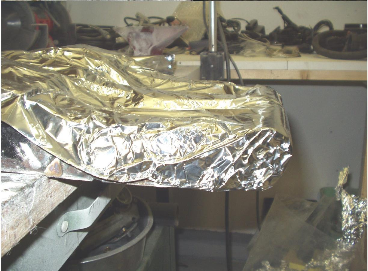
**2 Schichten Harz auftragen. Erste Schicht nur Harz. In der zweiten Schicht wird schon Glasfasermatte mit eingearbeitet.**
