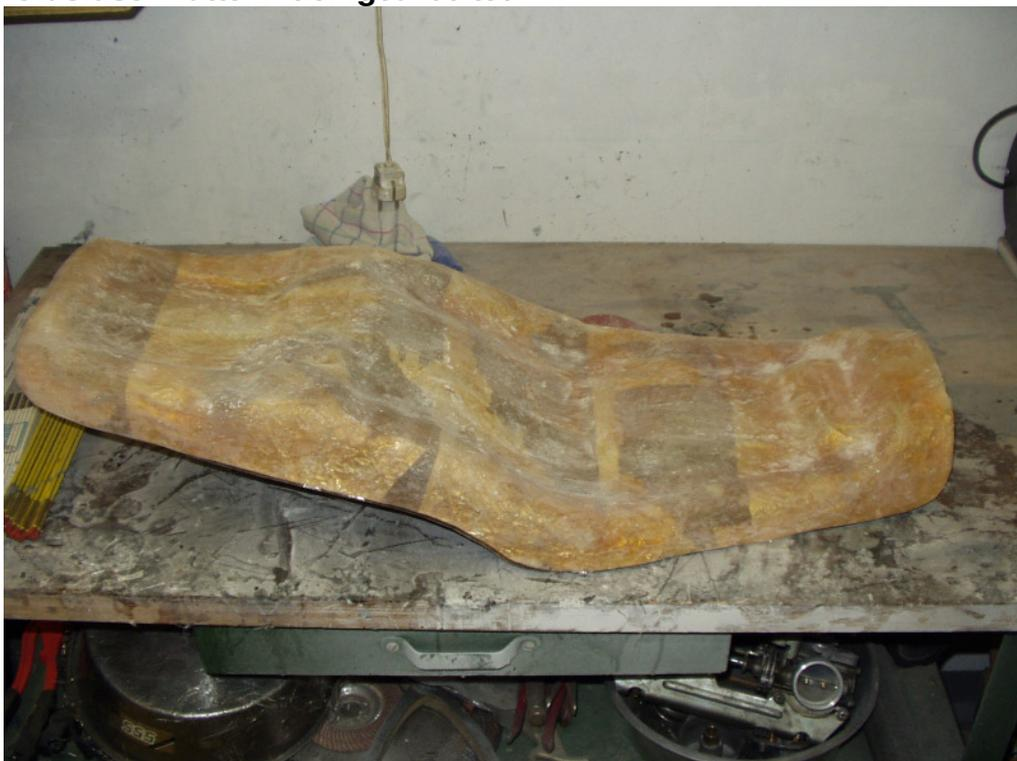
**Ablösen nach Trocknung der zweiten Schicht**
